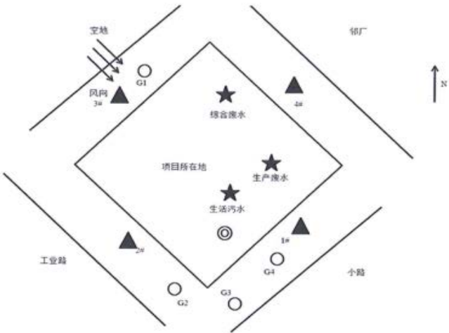
图 1.监测布点示意图 (▲噪声监测点,⊙有组织废气监测点,○无组织废气监测点,★废水监测点)
